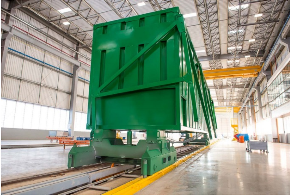
图5 总共13个牵引绳驱动器确保每个工作步骤后的下一步四驱车运输。驱动器依次排列，以便在确认后可在每个工作站进行单独运送。
