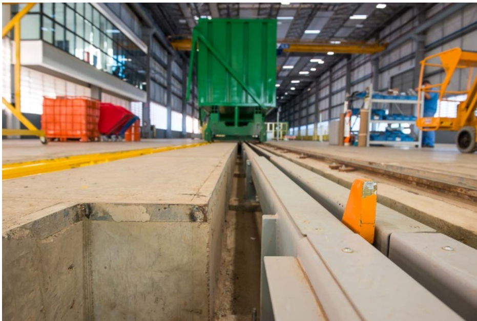
图6 每个输送部分的终端，牵引绳将工件拉到下一站。虽然生产线是连续的，通过这种方式，可在每个工作站停留不同的时间。
