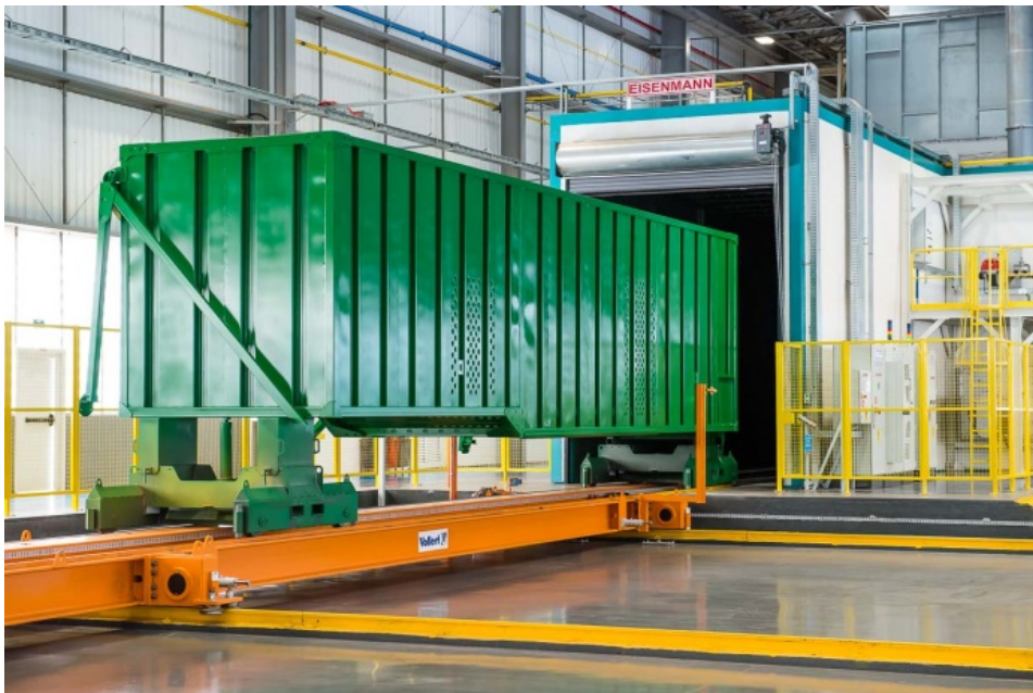
图4 烘干后的出舱由第二个重型移动平台执行，它将车厢和拖车分配至两条平行的组装线安装轮胎。
