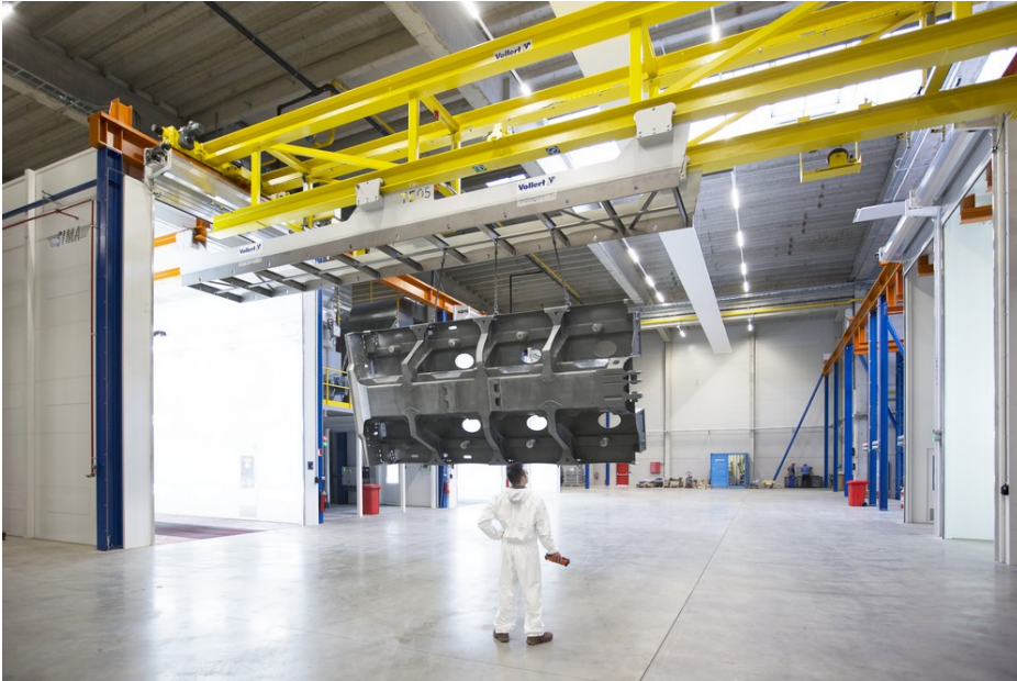
图 1 在涂层时，Faymonville 采用了带摩擦轮双轨挂道，平行的工作站可节省空间地布局。
