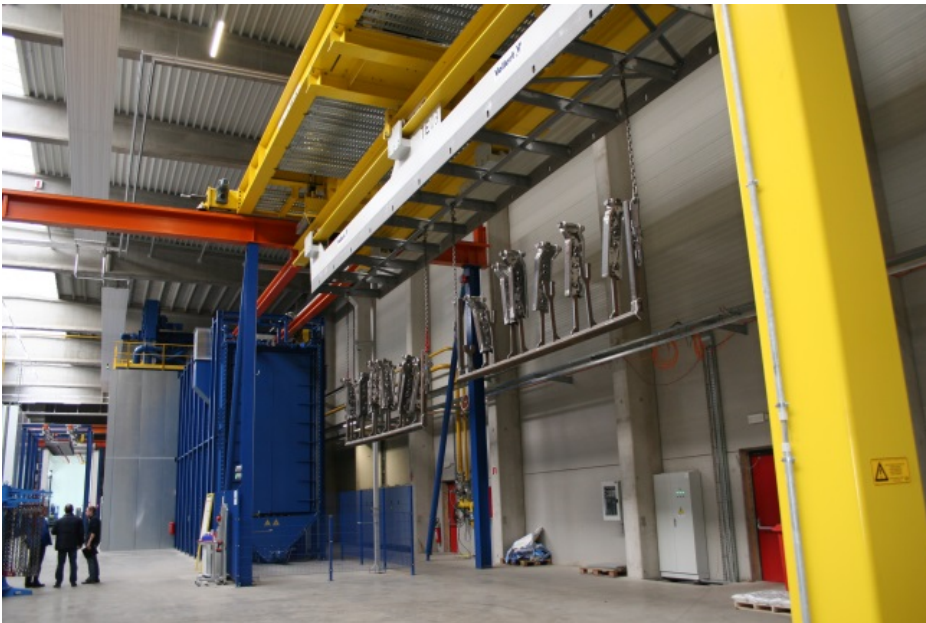
图 2 工件可以单个或多个的悬挂于运输单元，分配机械手（黄色）将它们运输到各个工作室。
