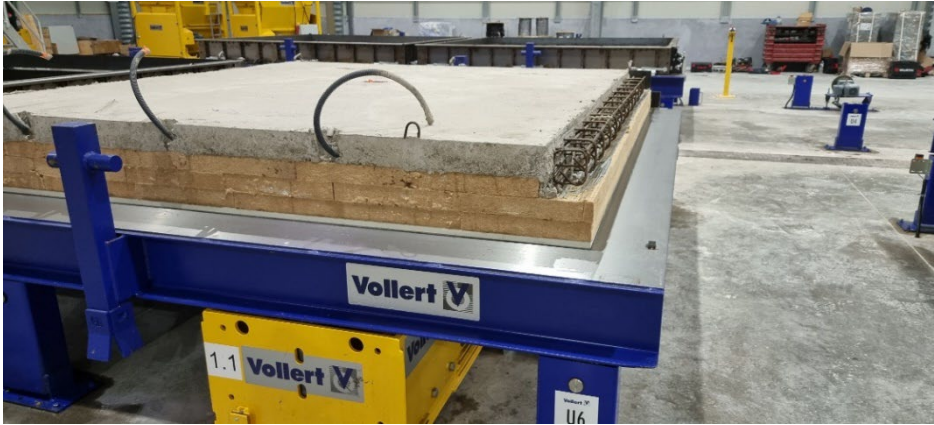
图 7： 为了减少生态足迹，在夹心墙体的隔离方面也采用了新方法。
