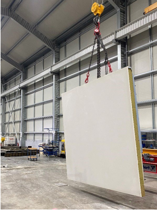
图 9： 由此，以高强度混凝土制成的外立面厚度仅为 25 毫米。
