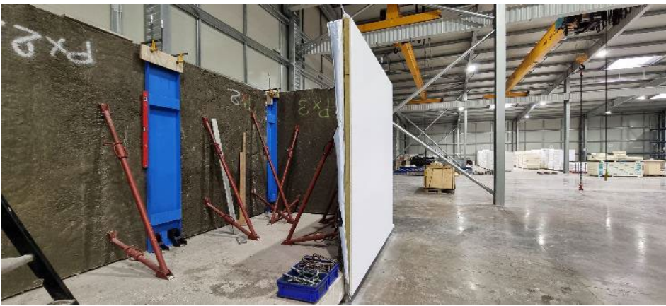
图 10： 建筑楼层的所有单个模块都已预先组装并相互匹配。从而确保在施工现场顺利组装。
