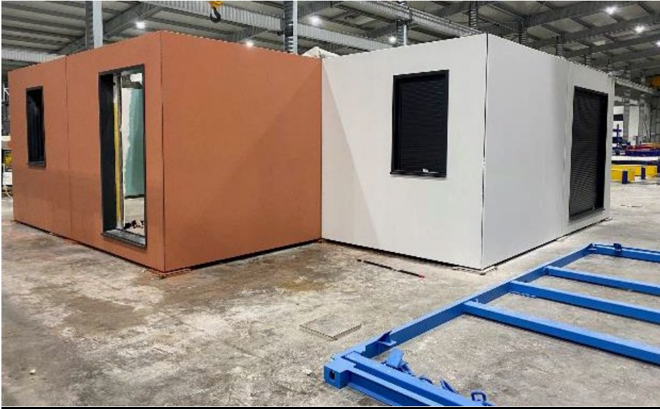
图 11 : 所有水电管道均已预装。在不久的将来，卫生间和厨房也将实现预组装。
