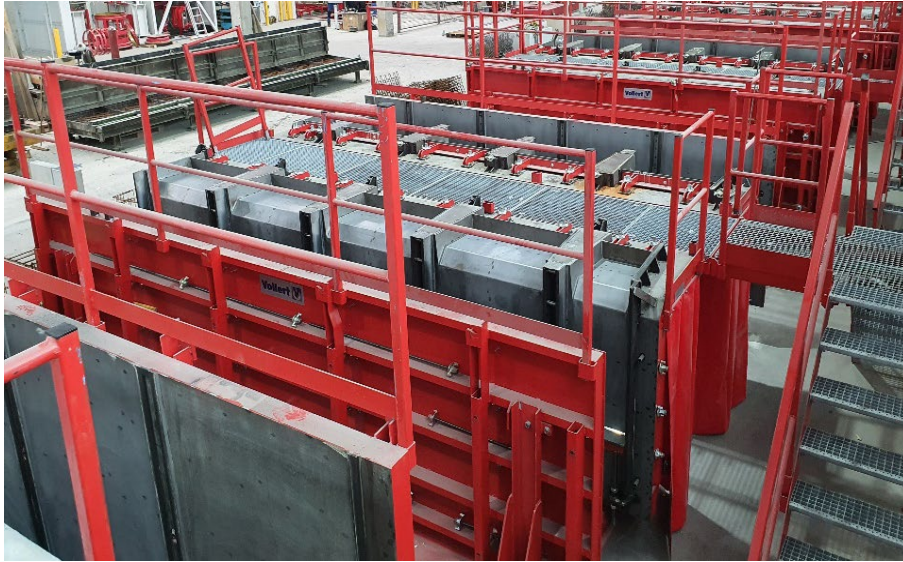
图 1 : 双联模板为墙砖生产提供了极为经济的解决方案。
