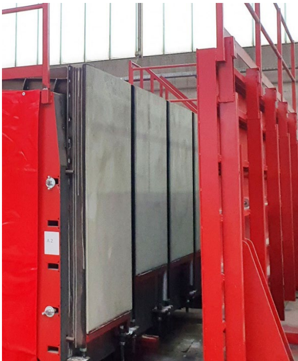
图 4： 墙砖以架空方式生产，这保证了优异的表面质量。
