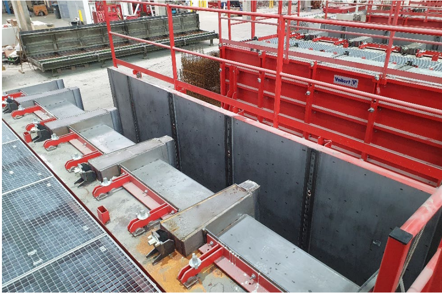
图 3： 中间切断装置被坡口几何形状分开。
