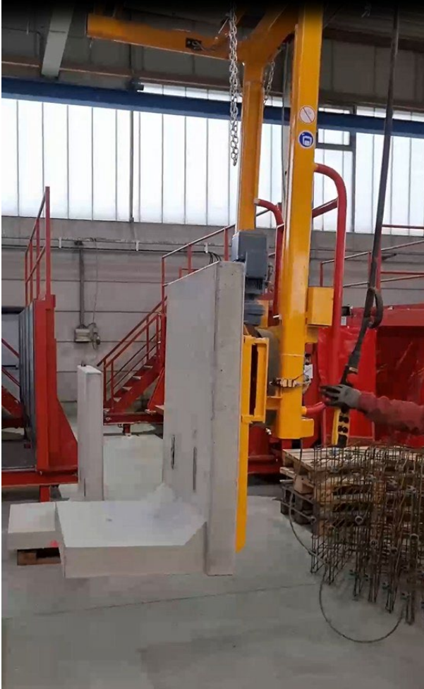
图 7： 为了在脱膜后从模板中安全地取出 L 形墙砖，受起重机控制的真空起重横梁是理想选择。
