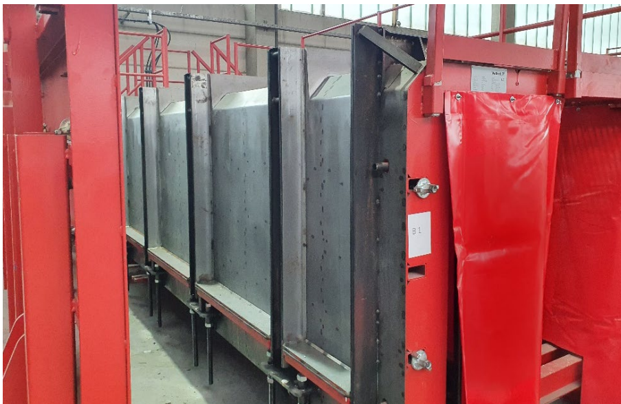
图 2 : 在每个串联模板中都可以生产 8 个宽度为 99 cm 的 L 形元件以及各 2 个宽度为 49 cm 的 L 形元件。
