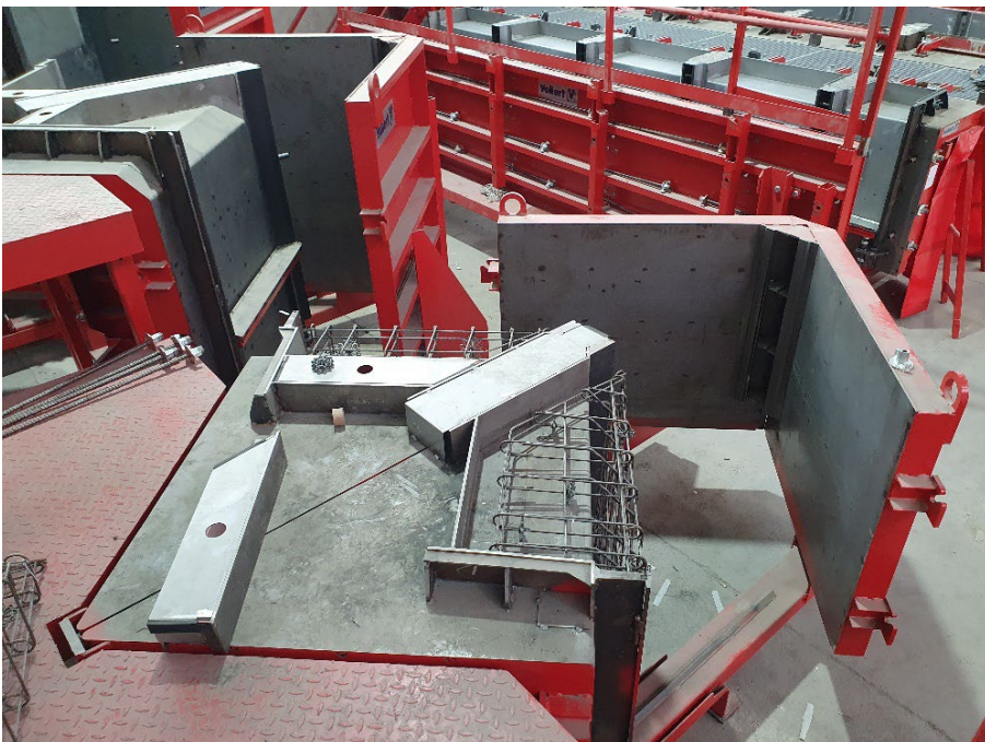
图 6： L 形侧模板以气动方式沿对角线方向移动，由此可实现安全的脱膜过程。
