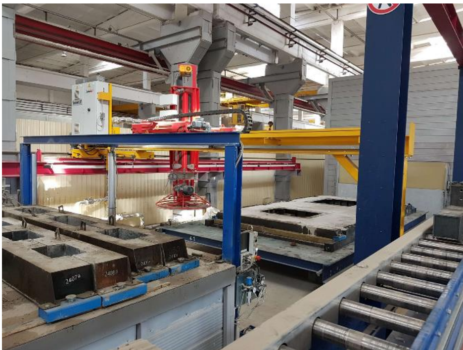
图 8 电动 Vario SMOOTH 平滑机在纵向和横向上移动，确保表面光滑。
